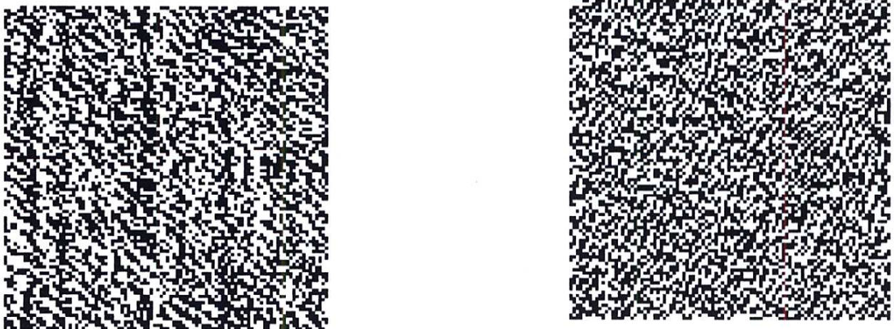
Rys. 2. Przykłady binarnych hologramów cyfrowych (matryca 100×100 pikseli). Piksele wykazują dwa stany – czarny (brak transmisji) „0” i biały (transparentny) „1”
