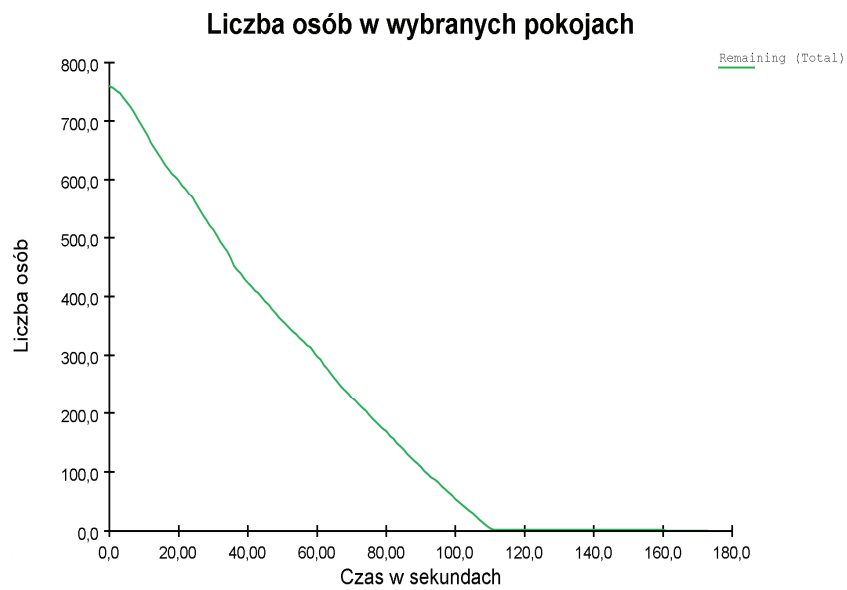
Rys. 8. Model zmienno-sterujący – czas ewakuacji ludności ze wszystkich zamodelowanych pomieszczeń
