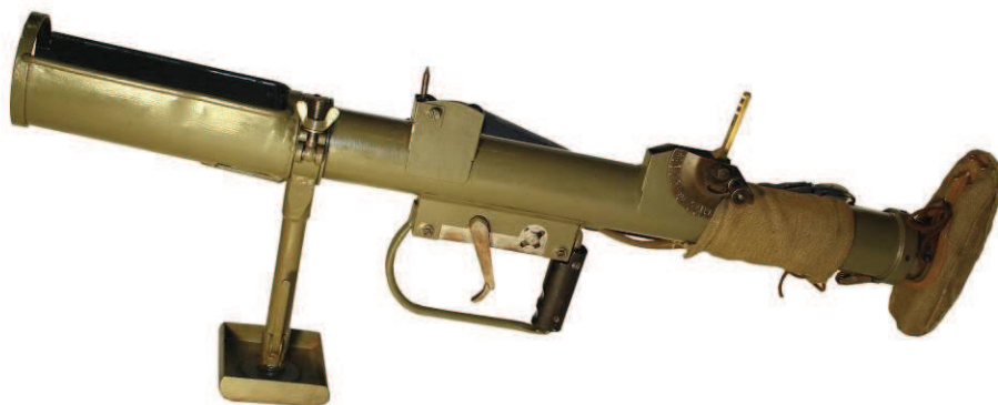
Zdjęcie 4. Miotacz przeciwpancerny PIAT w wersji z teleskopowo wyciąganym podnóżkiem i dodatkowym bocznym celownikiem do strzelań stromotorowych. Źródło: P. Witkowski.
