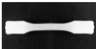
Rysunek 56. Zdjęcie makroskopowe kształtki EV
