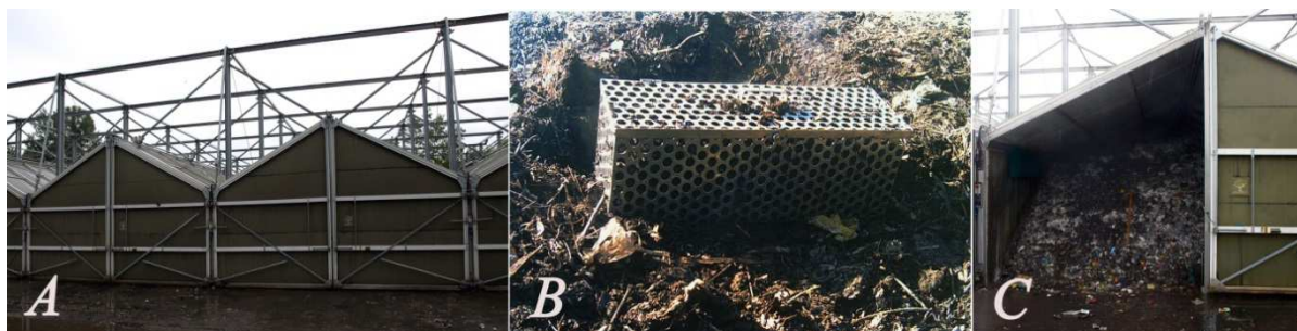
Rysunek 17. Zadaszone tunele systemu Biodegma (A), kosze ze stali nierdzewnej z przygotowanymi próbkami przed degradacją (B) oraz stanowisko badawcze (C)
