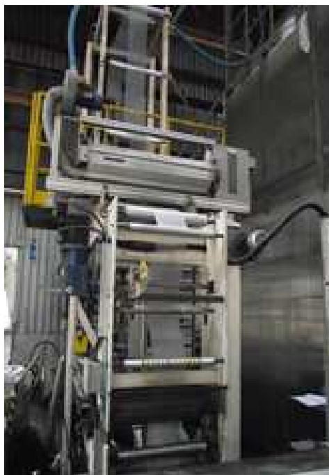
Rysunek 14. Linia do produkcji folii
