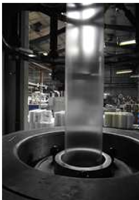
Rysunek 15. Proces produkcji folii
