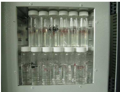
Rysunek 16. Komora badań cieplnych z próbkami folii z 40PLA
