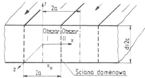
Rys. 1. Przekrój modelu domenowego anizotropowej blachy
