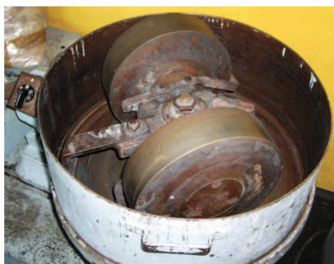
Rys. 1. Mieszarka bębnowa znajdująca się w laboratorium Katedry Odlewnictwa Politechniki Częstochowskiej
