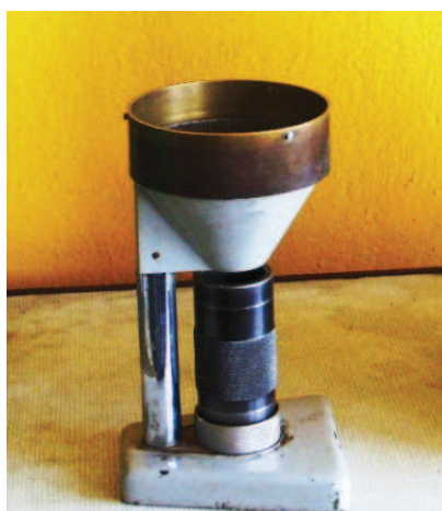
Rys. 5. Przystawka do przesiewania masy do badania zagęszczalności
