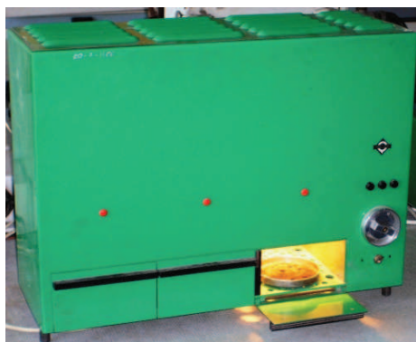
Rys. 2. Suszarka pośpieszna trójstanowiskowa typu LAPS
