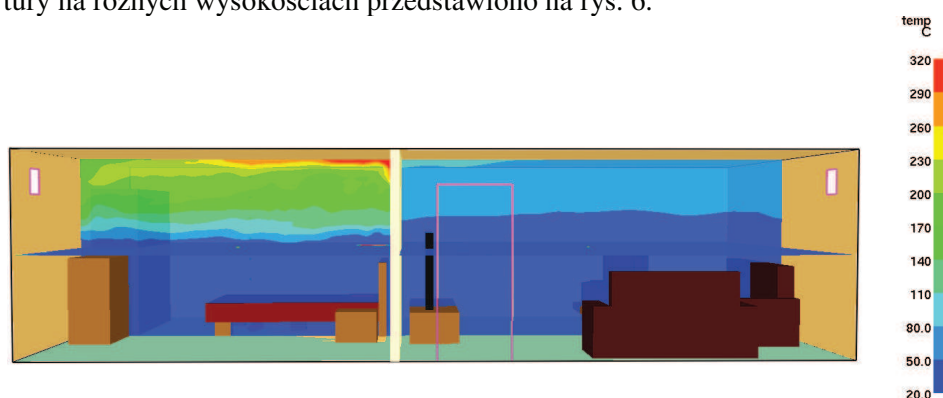
Rys. 6. Rozkład temperatury w domenie obliczeniowej dla pianki PU
