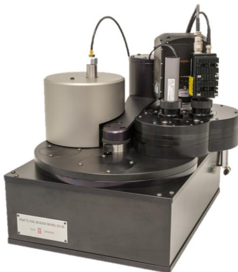
Rysunek 5.3.1. Czytnik Risø TL/OSL-DA-20 (fot. zaczerpnięta z: Guide to „The Risø TL/OSL Reader”, DTU, Denmark, June 2017)
