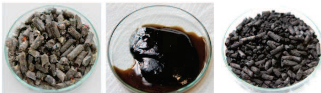
Rysunek 3. Zdjęcia: materiał wsadowy, frakcja olejowa oraz karbonizat uzyskane w wyniku procesu pirolizy frakcji RDF, źródło: materiały własne – Metal Expert Sp. z o.o. Sp. J.
