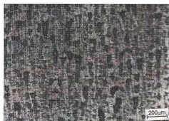
Rys. 2. Fragment powierzchni próbki trawionej w roztworze 0,5 M \text{H}_2\text{SO}_4 w czasie 2 h, strona błyszcząca, mikroskop optyczny
