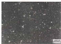
Rys. 3. Fragment powierzchni próbki trawionej w roztworze 1,4 M HCl w czasie 4 h, strona matowa, mikroskop optyczny
