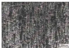
Rys. 4. Fragment powierzchni próbki trawionej w roztworze 1 M NaCl w czasie 4 h, strona matowa, mikroskop optyczny
