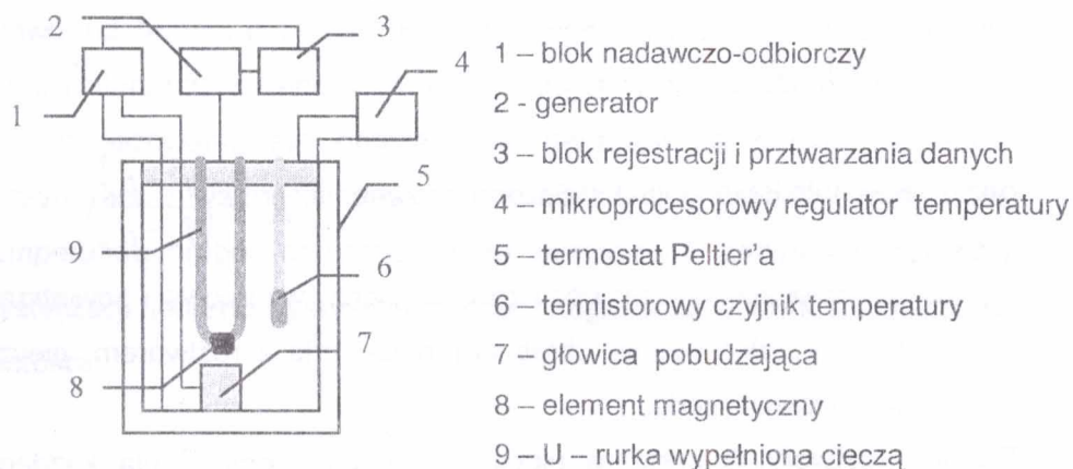
Rysunek 1. Schemat budowy densytometru.
