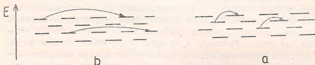
Rys. 1 Schematyczny obraz ruchu hoppingowego nośnika ładunku a) hopping aktywowany, b) hopping bezaktywacyjny
