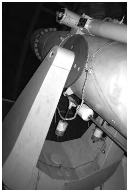
Montaż widłowy utrzymujący tubus teleskopu Schmidta w Obserwatorium Watykańskim w Castel Gandolfo. Fot.: S. Maffeo
